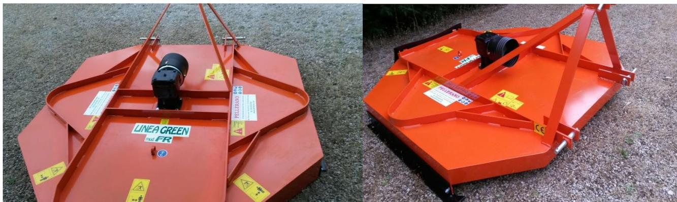
I trincia catena Linea Green Pellerano non sono soggetti al fenomeno dell'ingolfamento presente in tutti gli altri tipi di trincia quando si procede con una velocità d'avanzamento eccessiva. La ragione è molto semplice: la distanza tra gli organi che trinciano è molto grande per cui consente molto "scarico", cioè la fuoriuscita del materiale trinciato.
