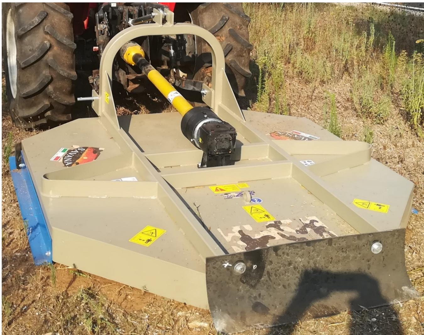
Il trincia a catene mod.ZX175 ha come caratteristiche principali un bassissimo assorbimento di potenza e la possibilità di lavoro in presenza di moltissima pietra e scoglio fisso affiorante. Trincia tranquillamente ogni tipo di erba ed infestanti di ogni tipo (acacie, cisto, rovi, canne, etc.) come anche potature di ogni tipo (meglio se ben secca).
